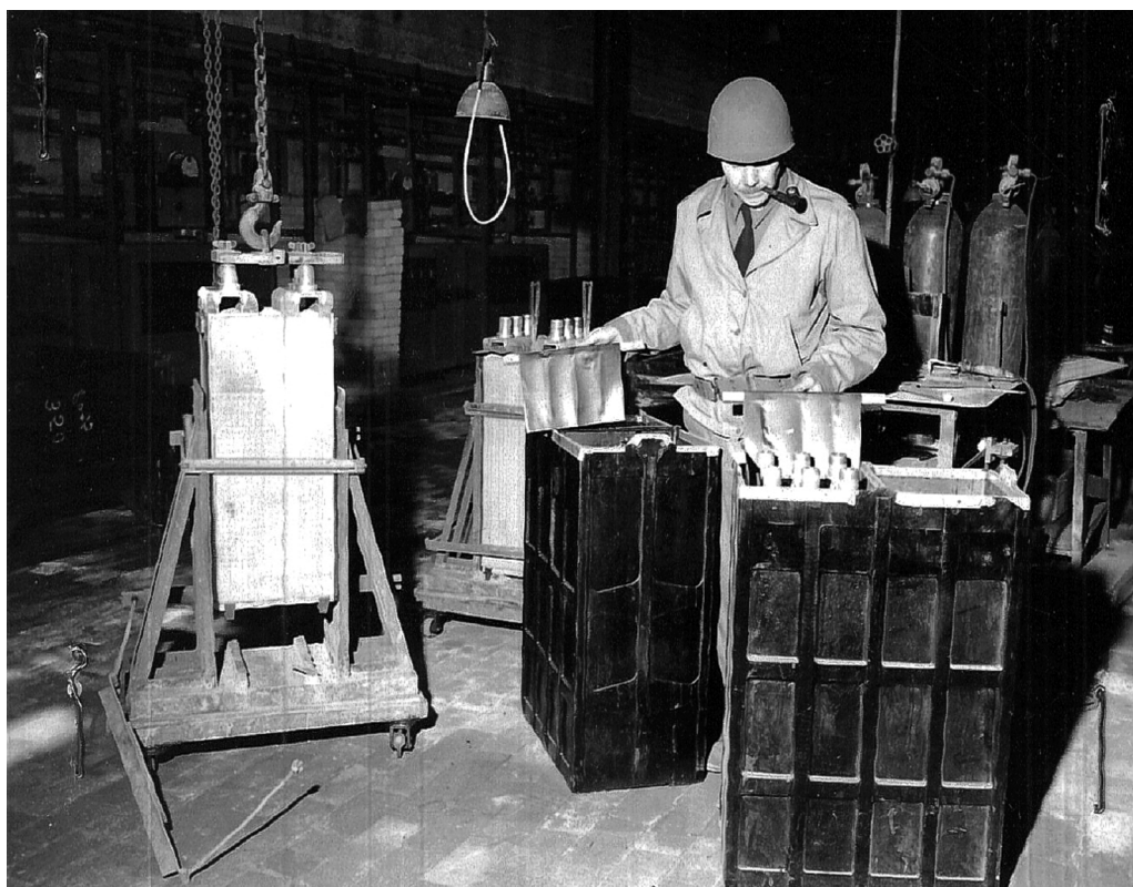
Lester Eugene Lighton (1894-1977), Leiter des Field Teams der U.S. Naval Technical Mission, überprüft Anfang Mai 1945 im Hagener AFA-Werk vor der Fertigstellung stehende Zellenelemente für U-Boote. Lighton war Manager der Electric Battery Co. in Philadelphia und dort Leiter des Department of Development and Design. (NARA College Park)
