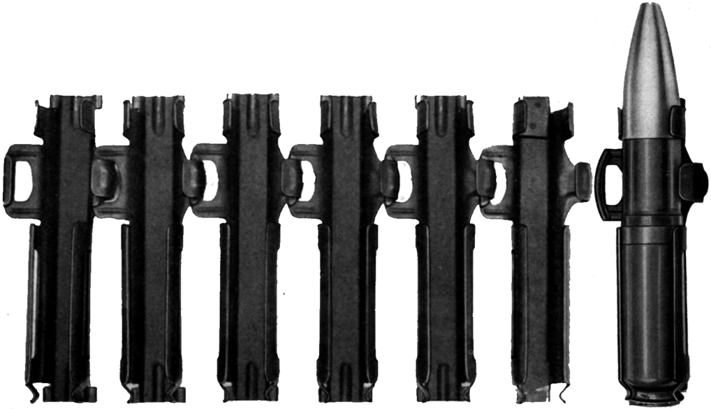
Zerfallgurt für die 1943 eingeführte schwere Bordwaffe MK 108 mit einem Geschosskaliber von 30 mm, den Ruberg & Renner 1942-1945 in Serie fertigte; rechts mit eingelegter 205 mm langer Patrone. (StadtA Hagen)
